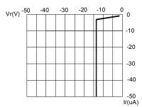
FIG.3 BLUE & GREEN REVERSE CURRENT VS. REVERSE VOLTAGE.
