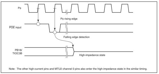
Figure 12.2 Falling Edge Detection
